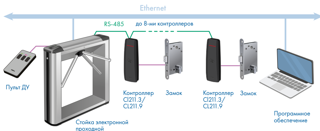
Структурная схема подключения электронной проходной
